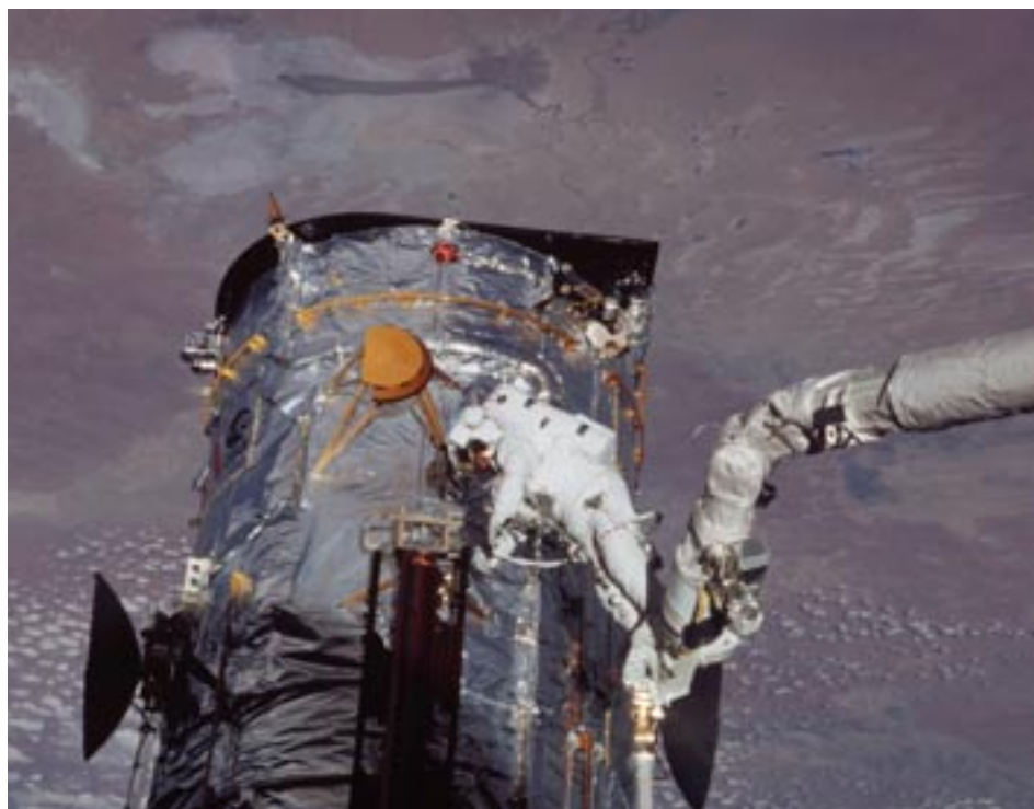
Obr.13-9 Astronaut Michael J. Massimino pracuje zavěšený na mechanickém manipulátoru na Hubblově kosmickém dalekohledu při misi STS-109.
